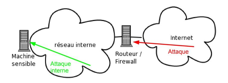
Les règles de filtrage du firewall sont sans effet contre une attaque venant de l'intérieur
